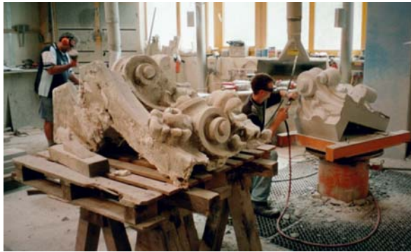
Abbildung 12: Fertigung der korinthischen Kapitelle für die Kathedrale St.Gallen; Gebrüder Müller AG, Neuhaus
