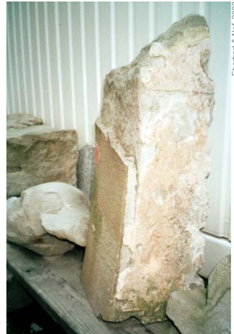
Abbildung 6: Schalenbildung an einem granitischen Sandstein der Kathedrale von 1928-1938
